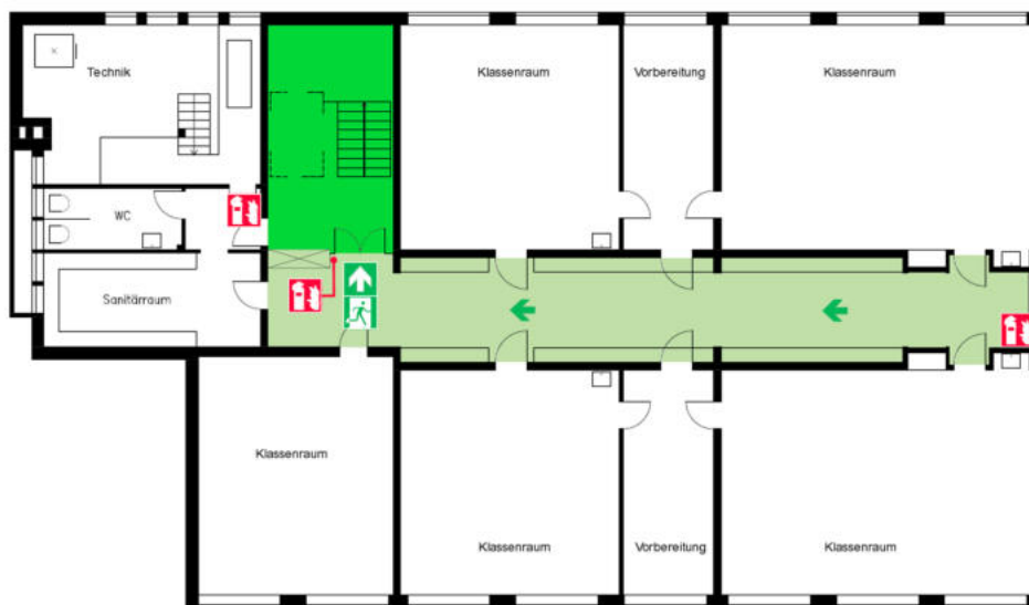
Abbildung 1: Problematische Schule mit notwendigem Flur aber nur einem baulichen Rettungsweg
